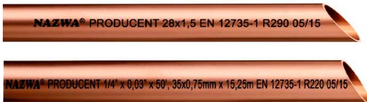
Rysunek 3.1 Przykład oznaczania rury miedzianej stosowanej w chłodnictwie i klimatyzacji
